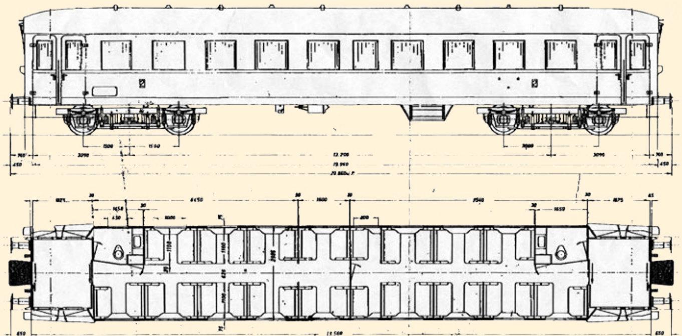
DRG 74488 «Berlin», Deutsche Reichsbahn, BJ 1940, 2. Klasse, 68 Plätze, RIC: D/A/CH, v_{\max}=140 km/h
